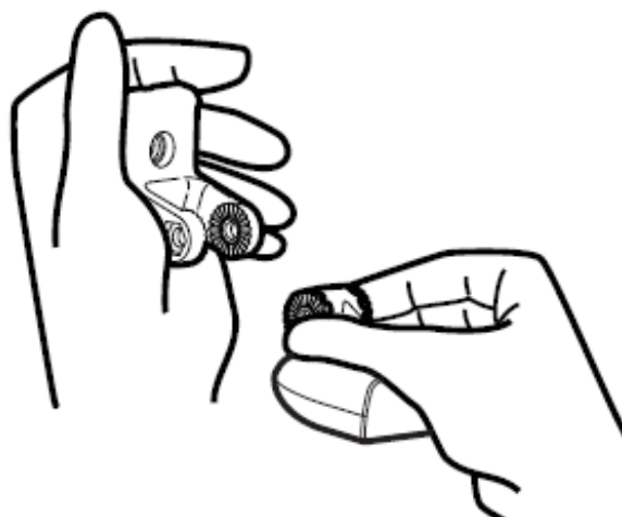
Вставка лапки пивота поверх храповиков
